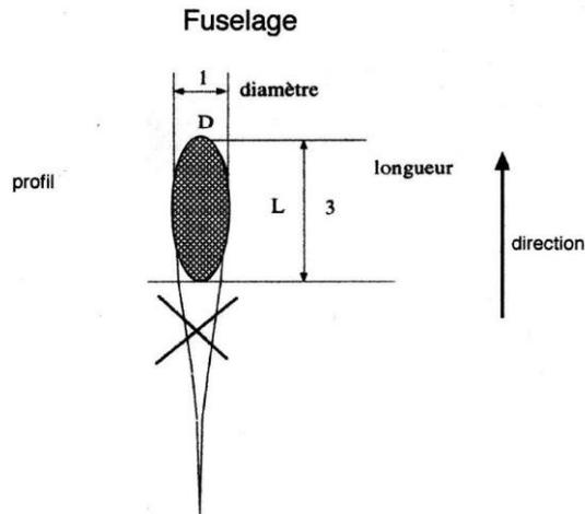
Le fuselage consiste à allonger ou effiler un profil. Le fuselage est toléré dans la mesure où le rapport de la longueur L au diamètre D ne dépasse pas les spécifications dimensionnelles établies telles que définies aux articles 1.3.020 (cadres), 1.3.022 et 1.3.023 (guidons, cintres de base et extension fixe du cintre de contre-la-montre).
