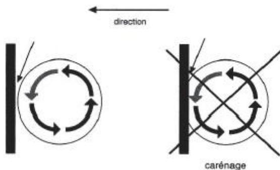
Le carénage consiste à utiliser ou à déformer un élément de la bicyclette de manière à ce qu'il enveloppe une partie mobile de la bicyclette comme les roues ou le pédalier. Ainsi il doit être possible de faire passer entre la structure fixe et la partie mobile une carte rigide type « carte de crédit ».
