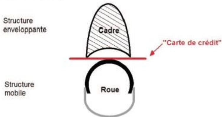
moyen pratique pour vérifier l'existence d'un carénage sur une pièce mobile comme la roue : il doit être possible de faire passer (entre les deux structures) une carte rigide type "carte de crédit".
